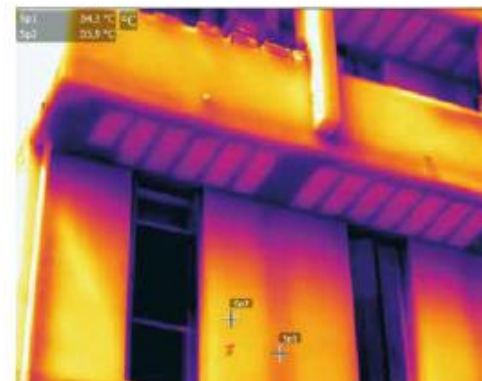
Facciata di edificio, \Delta T = 1.6\text{ °C} giugno, esposizione nord-est, pranzo
