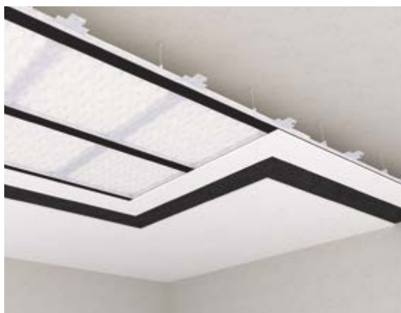
↑ Controsoffitto con intercapedine, inserimento di materiale isolante e finitura con doppia lastra
