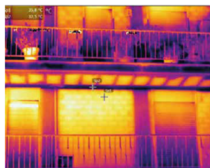
Facciata di edificio, \Delta T = 3.3\text{ °C} giugno, esposizione sud, ora di pranzo
